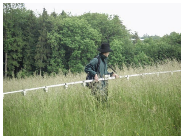
Abb. 4 | Ein getragener ISA-Wildretter mit Infrarotsensoren hilft Rehkitze sicher in Wiesen aufzuspüren. (Foto: Nicole Berger)
